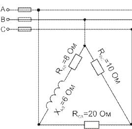
В трехфазную четырехпроводную сеть с линейным напряжением  $U_H = 380\text{В}$  включили разные по характеру сопротивления. Определить линейные токи и начертить векторную диаграмму цепи.
