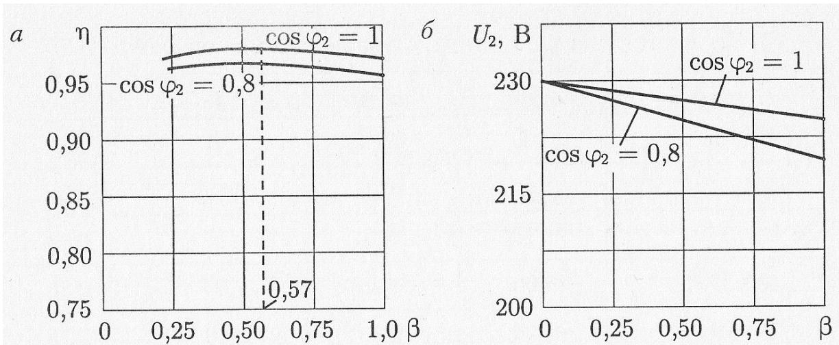
Рис. 1.8 Зависимости  $\eta = f(\beta)$  и  $U_2 = f(\beta)$  трансформаторов
