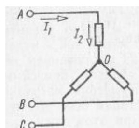
8. Между различными точками схемы включены вольтметры. Какой из них показывает линейное напряжение, какой фазное
