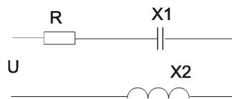
В трехфазную четырехпроводную сеть с линейным напряжением  $U_H = 220$  В включили звездой разные по характеру сопротивления. Определить линейные токи и начертить векторную диаграмму цепи. Определить ток в нулевом проводе.
