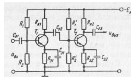
23. Как изменится напряжение на коллекторе  $U_{K \text{ НАС}}$  в схеме каскада в импульсном режиме работы транзистора при увеличении тока базы до  $I_{B \text{ н}}$
