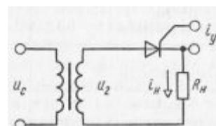
17. Как изменится коэффициент пульсации в схеме выпрямителя с емкостным фильтром, если  $R_H$  уменьшится
