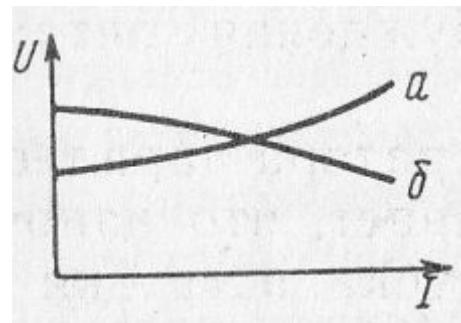
29. Как следует включить обмотки возбуждения компаундного генератора постоянного тока, чтобы уменьшить влияние тока нагрузки на напряжение генератора
