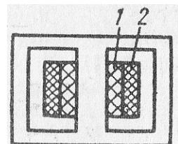
3. Сколько стержней должен иметь магнитопровод трехфазного трансформатора
