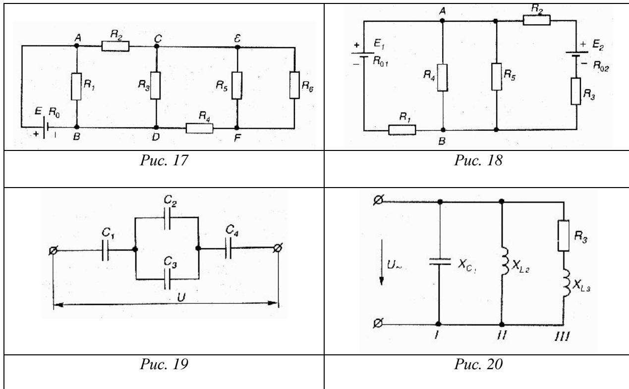
**Задача 4.** В сеть переменного тока с напряжением  $U = 220$  В, частотой  $f = 50$  Гц включена цепь (рис. 20).
