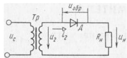
16. Каковы показания амперметров, реагирующих на среднее значение тока, один из которых включен в цепь вторичной обмотки трансформатора, а другой – в цепь  $R_H$
