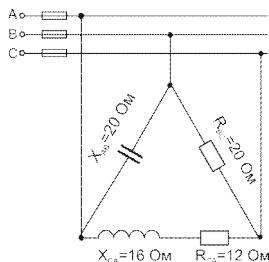
В трехфазную четырехпроводную сеть с линейным напряжением  $U_H = 380\text{В}$  включили разные по характеру сопротивления. Определить линейные токи и начертить векторную диаграмму цепи.
