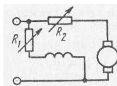
31. Как изменится частота вращения двигателя при уменьшении: а)  $R_1$ , б)  $R_2$
