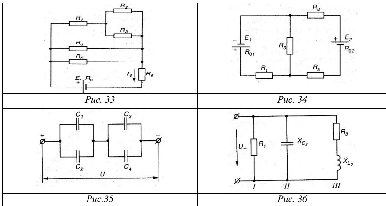
**Задача 3.** В цепи (рис. 35)  $C_1 = 1$  мкФ,  $C_2 = 2$  мкФ,  $C_3 = C_4 = 2$  мкФ,  $U = 60$  В.
