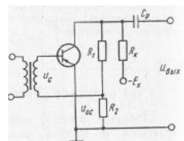
21. Из каких резисторов составлены делители постоянного и переменного напряжений в схеме усилителя с отрицательной обратной связью
