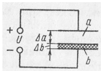
4. При неизменном напряжении увеличилось расстояние между пластинами конденсатора. Как изменится при этом заряд конденсатора
