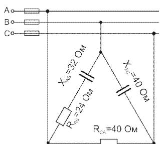
В трехфазную четырехпроводную сеть с линейным напряжением  $U_H = 220\text{В}$  включили разные по характеру сопротивления. Определить линейные токи и начертить векторную диаграмму цепи.
