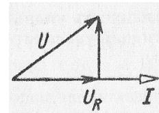
5. Как влияет реактивное сопротивление на ток в режиме резонанса напряжений
