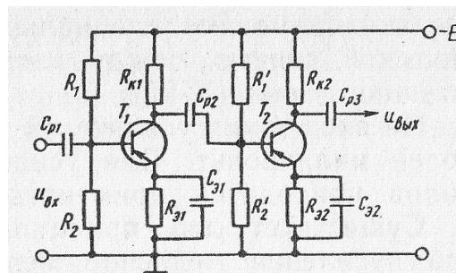
22. Как изменится напряжение на коллекторе  $U_{K\text{ нас}}$  в схеме каскада в импульсном режиме работы транзистора при незначительном уменьшении сопротивления  $R_K$
