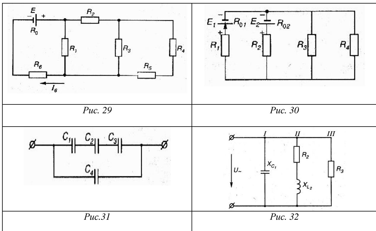
**Задача 4.** В сеть переменного тока с напряжением  $U = 100$  В включена цепь (рис. 32). В первую ветвь включено сопротивление  $X_{C1} = 100$  Ом, во вторую —  $R_2 = 60$  Ом,  $X_{L2} = 80$  Ом, в третью —  $R_3 = 200$  Ом.
