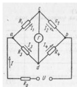
18. Дано:  $R_1 = 10 R_3$ . Мост оказался уравновешенным при  $R_2 = 10$  Ом. Определить  $R_4$
