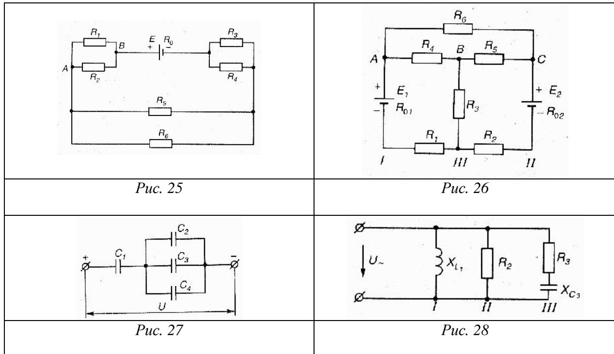
**Задача 3.** В цепи (рис. 27)  $C_1 = 3 \text{ пФ}$ ,  $C_2 = 1 \text{ пФ}$ ,  $C_3 = 2 \text{ пФ}$ ,  $C_4 = 3 \text{ пФ}$ ,  $U_2 = 20 \text{ В}$ .
