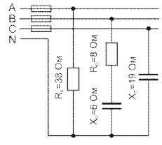
В трехфазную четырехпроводную сеть с линейным напряжением  $U_H = 380$  В включили звездой разные по характеру сопротивления. Определить линейные токи и начертить векторную диаграмму цепи. Определить ток в нулевом проводе.
