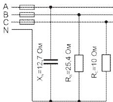
В трехфазную четырехпроводную сеть с линейным напряжением  $U_H = 220$  В включили звездой разные по характеру сопротивления. Определить линейные токи и начертить векторную диаграмму цепи. Определить ток в нулевом проводе.
